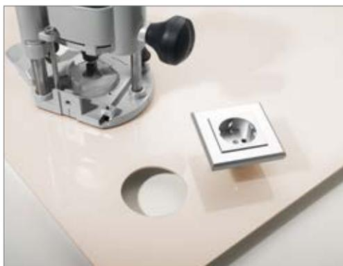
RAUVISIO crystal slim – это 4 мм панель, состоящая из стеклянного ламината, спрессованного с подложкой соответствующего цвета. В отношении обработки он проявляет те же особенности, что и RAUVISIO crystal. Эта тонкая стеклянная панель особенно подходит для замены секций с керамическим покрытием, а также для зон с повышенной влажностью. Необходимые отверстия по требованию клиента, например, для розеток можно сделать и непосредственно на месте монтажа.
